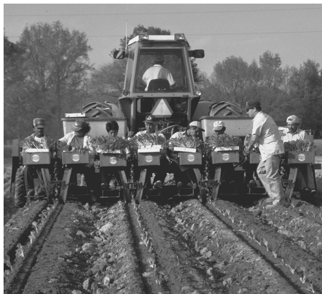
Figura 64.29 • Trasplante mecánico del tabaco curado al humo en Carolina del Norte (Estados Unidos).
