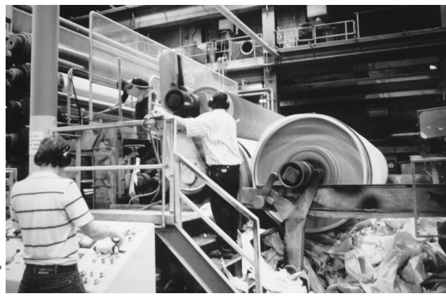
Figura 72.10 • Extremo seco de una máquina de papel mostrando la bobina de papel y al trabajador utilizando la cizalla de aire para cortar el extremo.
