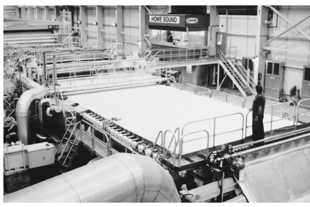
Figura 72.9 • Extremo húmedo de una máquina de papel mostrando fieltro de fibra sobre la rejilla.
