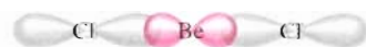
FIGURA 10.11 La geometría lineal del \text{BeCl}_2 se puede explicar suponiendo que el \text{Be} tiene hibridación sp . Los dos orbitales híbridos sp se solapan con los orbitales 3p de los dos cloros para formar dos enlaces covalentes.
