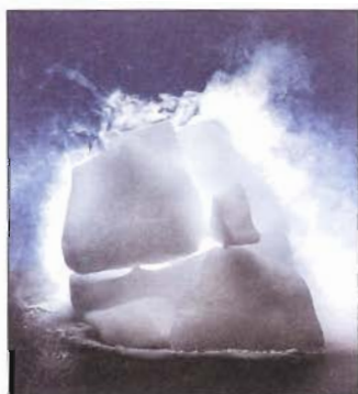
FIGURA 11.42 En condiciones atmosféricas, el dióxido de carbono sólido no se funde; sólo se sublima. El dióxido de carbono gaseoso frío (-78°C) hace que se condense buena parte del vapor de agua circundante formando una capa de neblina.
