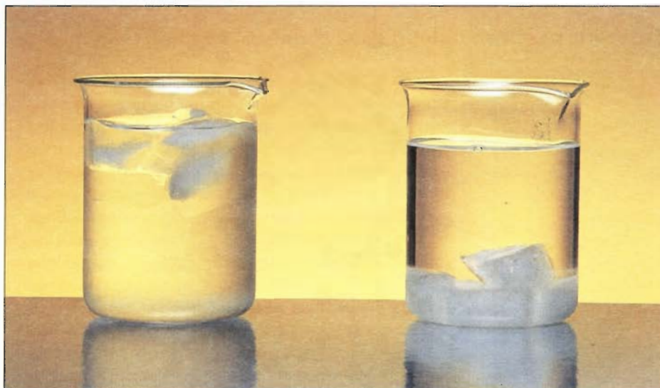
FIGURA 11.11 En el vaso del lado izquierdo los cubos de hielo flotan en el agua. En el vaso del lado derecho el benceno sólido se va al fondo en el benceno líquido.
