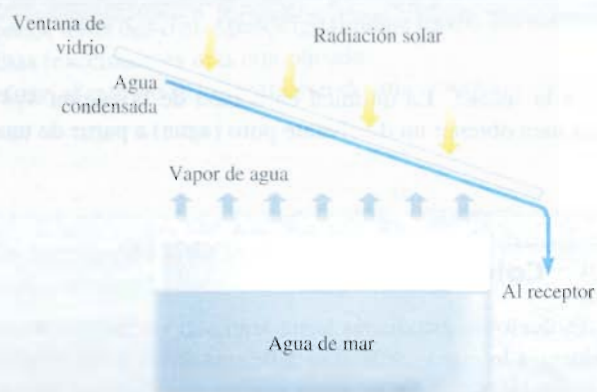
Un alambique solar para la desalinización del agua de mar.
