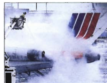
La descongelación de los aeroplanos se basa en la disminución del punto de congelación.
