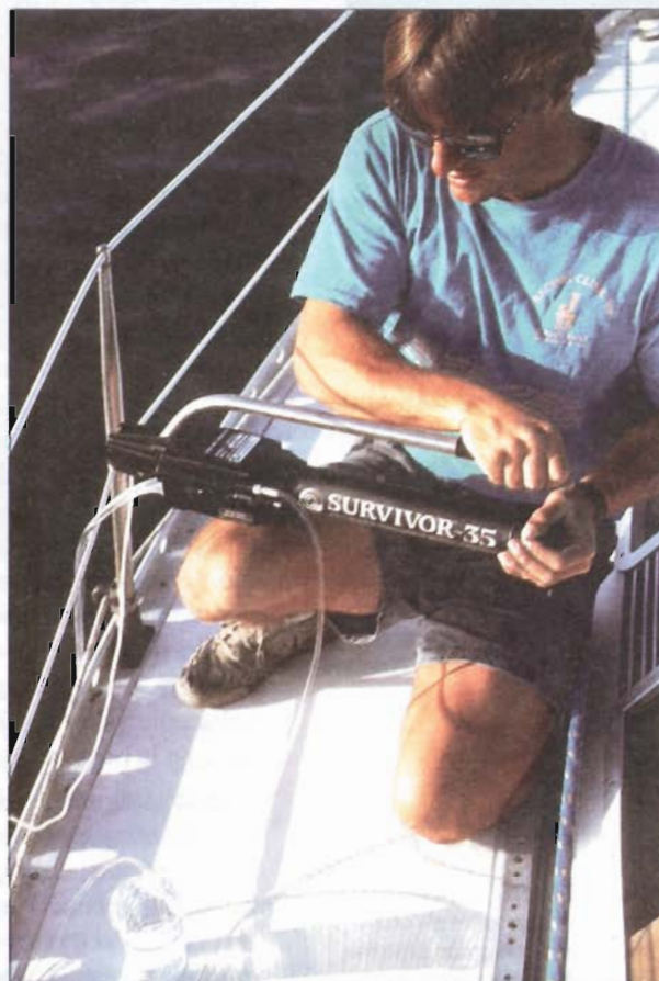
Un pequeño aparato de ósmosis inversa permite a una persona obtener agua potable a partir de agua de mar.
