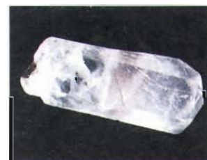
El mineral calcita está formado de carbonato de calcio, como la greda y el mármol.
