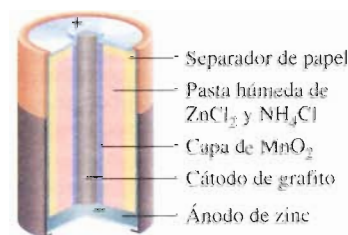
FIGURA 19.7 Sección interior de una celda seca como las que se utilizan en las lámparas y en los radios de transistores. En realidad, la celda no está completamente seca, ya que contiene una pasta electrolítica húmeda. El ánodo y el cátodo están aislados entre sí.
