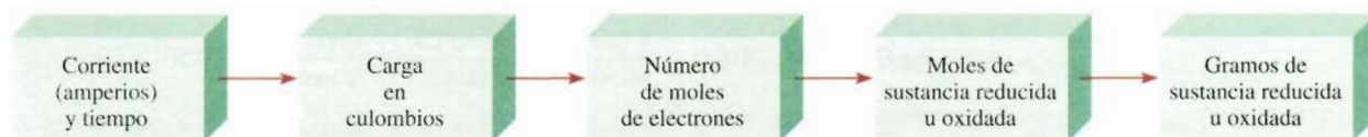
FIGURA 19.20 Etapas para calcular la cantidad de sustancias reducidas u oxidadas en la electrólisis.
