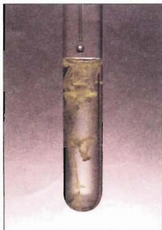
**FIGURA 4.3** Formación de un precipitado amarillo de  $\text{PbI}_2$  al agregar una disolución de  $\text{Pb}(\text{NO}_3)_2$  a una disolución de  $\text{NaI}$ .
