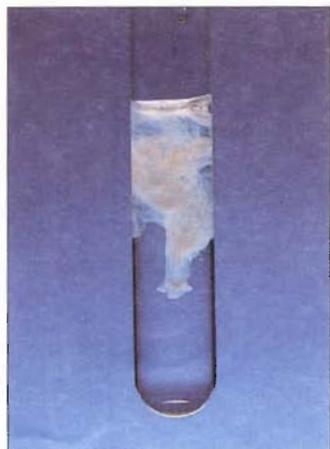
FIGURA 4.5 Formación del precipitado de  $\text{BaSO}_4$ .
