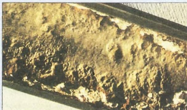
La incrustación en el calentador casi obtura esta tubería de agua caliente. El depósito consiste principalmente en  $\text{CaCO}_3$  con algo de  $\text{MgCO}_3$ .
