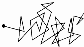
FIGURA 5.19 Recorrido de una sola molécula de gas. Cada cambio de dirección representa una colisión con otra molécula.
