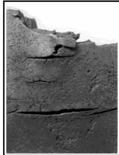
Figura 20. Fisuras cercanas a la zona de fractura, caso 3A, 20X [4].
