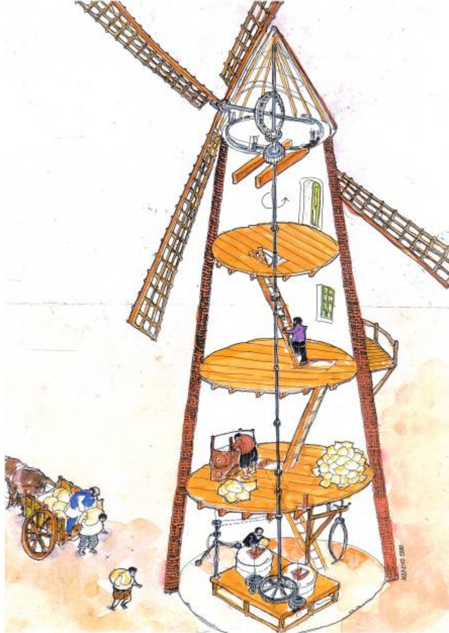
Corte molino de viento (c. 1840) Chacabuco
