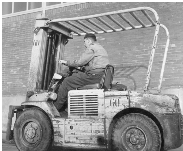
Figura 102.20 • Un dispositivo de protección superior instalado en una carretilla elevadora.
