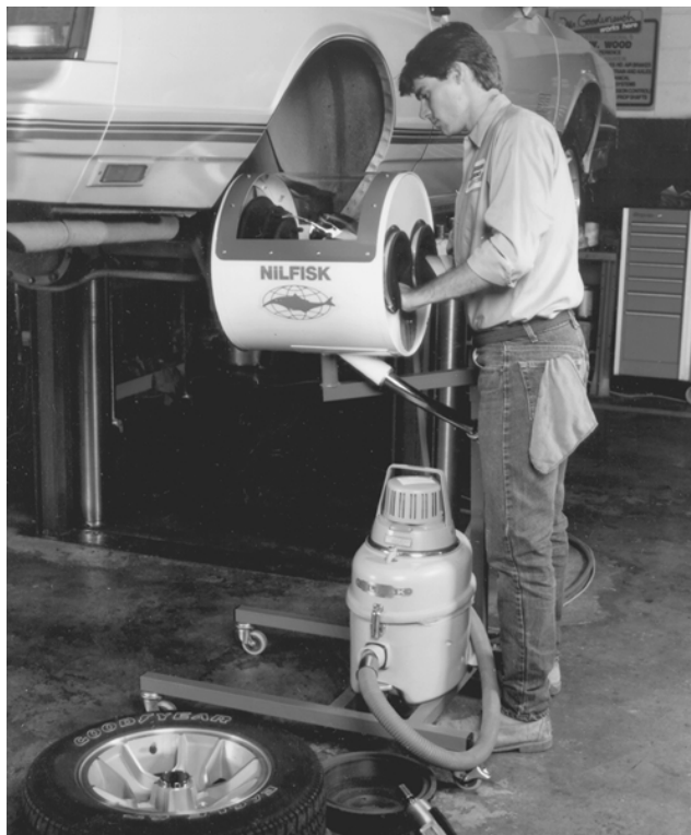
Figura 102.11 • Encapsulamiento portátil para la prevención de la exposición al polvo de amianto procedente de tambores de freno. Está equipado con una pistola de aire comprimido con una manga de algodón y conectado a un limpiador de vacío HEPA.
