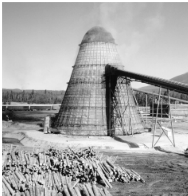
Figura 71.6 • Cintas de transporte de desechos a un quemador tipo colmena.
