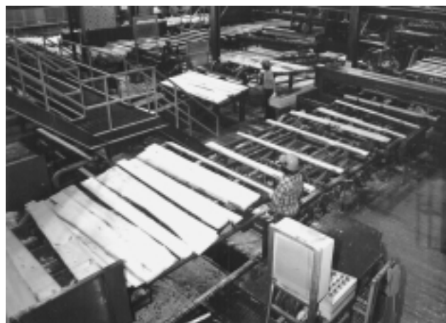
Figura 71.4 • Interior de la fábrica; cintas y rodillos de transporte de madera.
