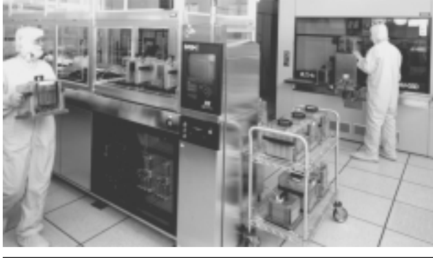
Figura 83.3 • Sala limpia en una zona de tecnología avanzada donde los operadores trabajan en la fabricación de semiconductores.
