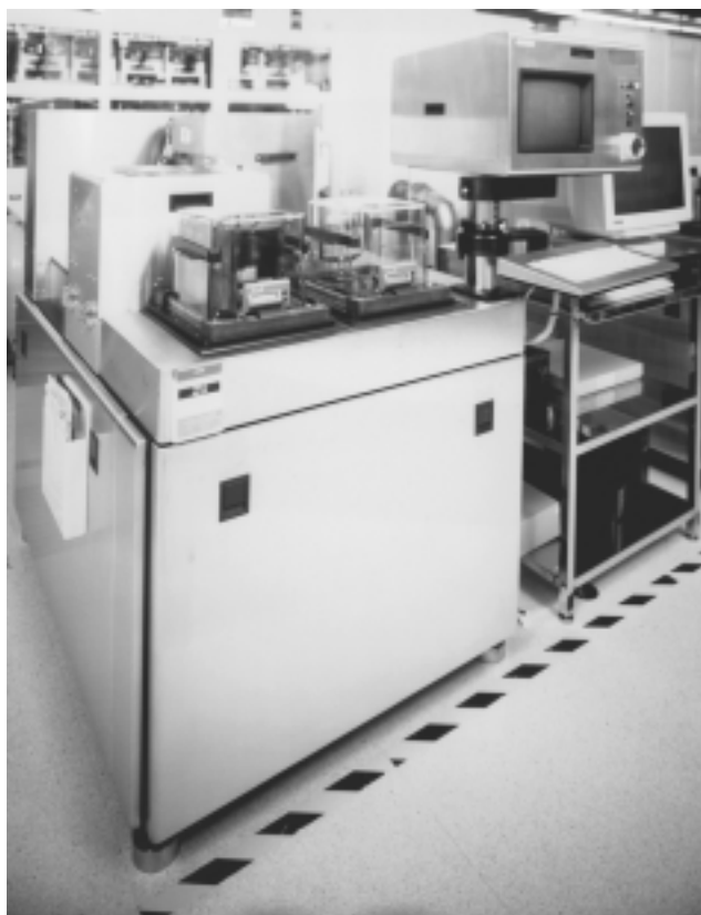
Figura 83.4 • Equipo fotolitográfico de "sala amarilla" en una sala limpia de tecnología avanzada.
