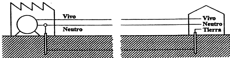
Figura 25.13. Concepto de tierra en una instalación de distribución de energía eléctrica. A la izquierda, la usina; a la derecha, el usuario.
